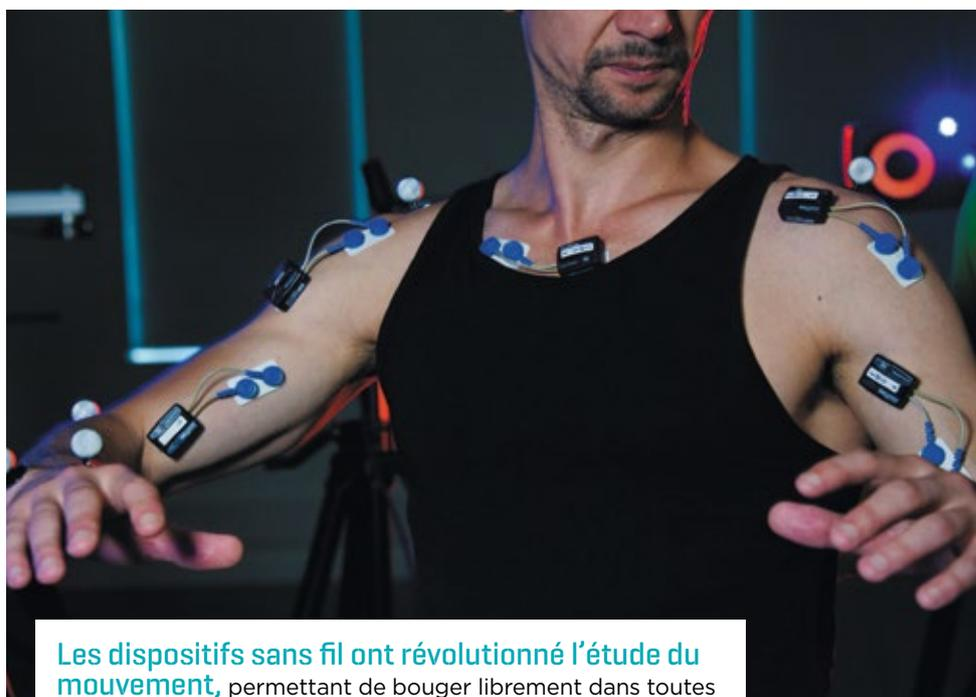
**Les dispositifs sans fil ont révolutionné l'étude du mouvement**, permettant de bouger librement dans toutes les directions de l'espace. En bleu, les électrodes enregistrent l'activité électrique des muscles. Les marqueurs (boules grises) envoient un signal infrarouge et permettent de transmettre des informations sur le mouvement.
