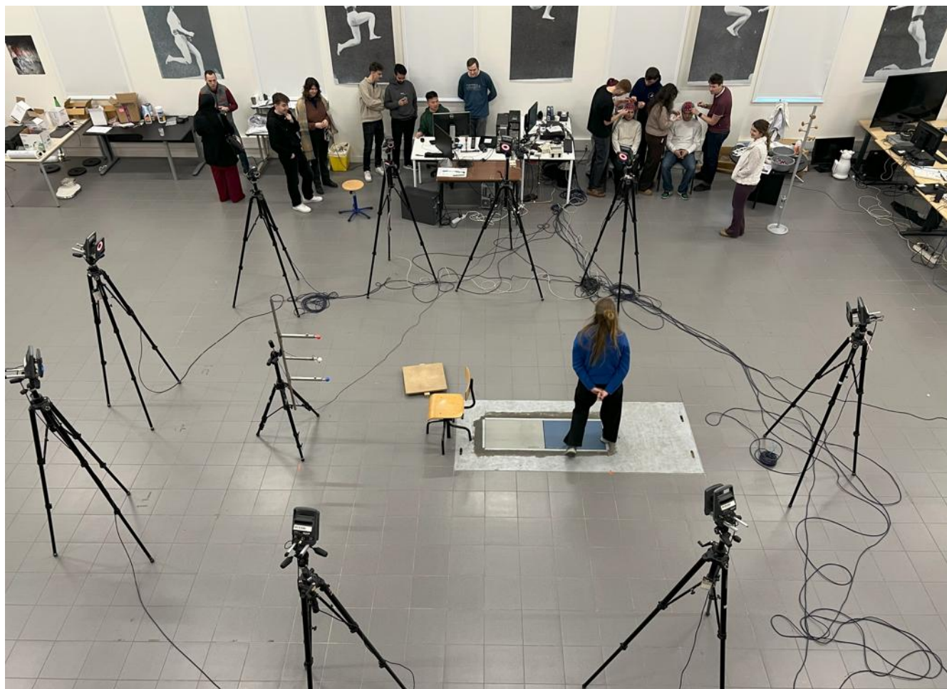
Ce dispositif fait de nombreuses caméras a pour but de reconstituer les mouvements de la personne se trouvant au centre. Photo J. D.
